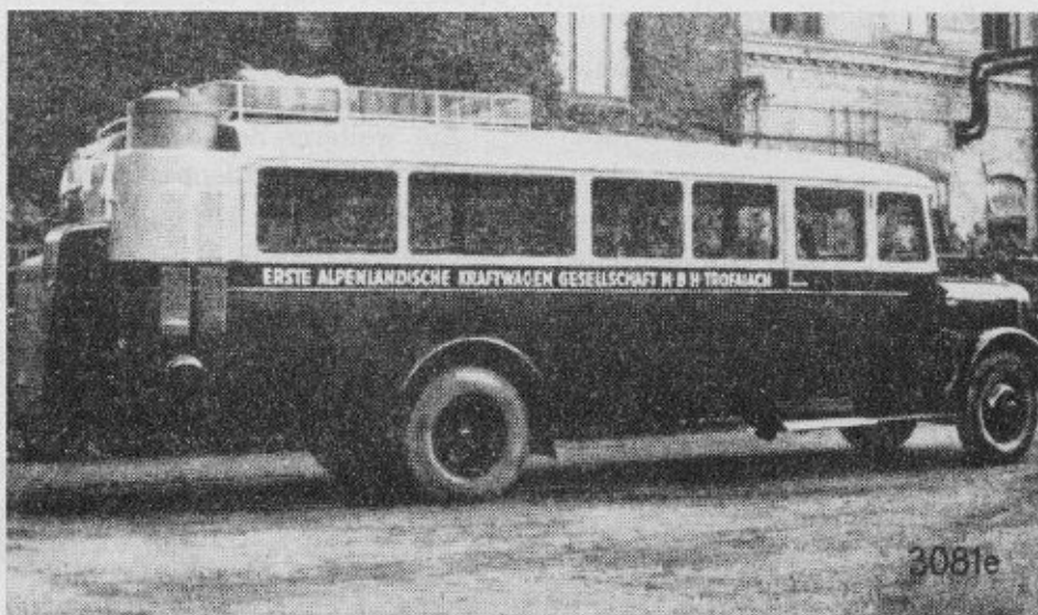
Bild 5. Umgebauter Autobus mit Saurer-Motor BN (Imbert-Gaserzeuger)
